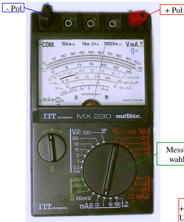
Bild 5 Analogmessgerät MX230 (Drehspulinstrument)
