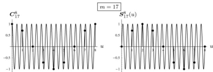
Zu jeder Komponente mit Wellenzahl  $m > M/2$  gibt es eine identische Komponente mit  $m \leq M/2$ . Durch diese Überlagerung können diese Komponenten aus dem abgetasteten Signal nicht rekonstruiert werden.
