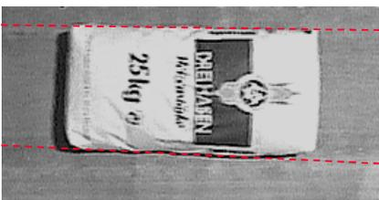
Das binarisierte Sobelbild zeigt eine deutliche Häufung von Kantenpixeln entlang der Sackumrisse. Viele zusätzliche Kantenpixel entstehen durch das Muster des Sackaufdrucks.
