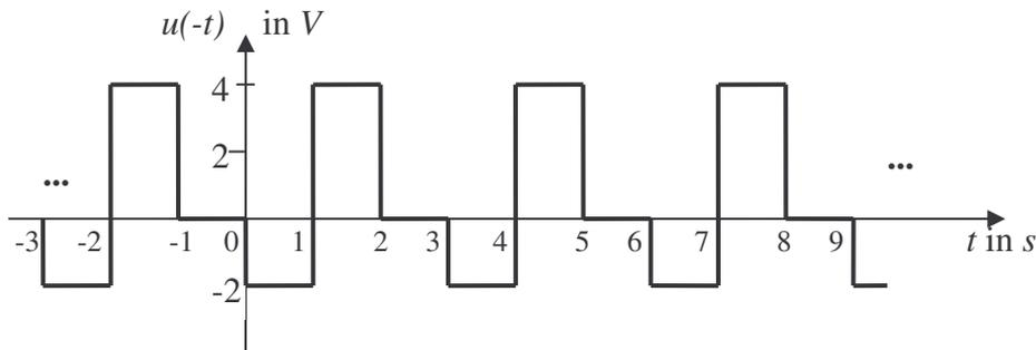
Ermittlung des geraden Anteils  $u_g(t)$  durch grafische Addition gemäß
