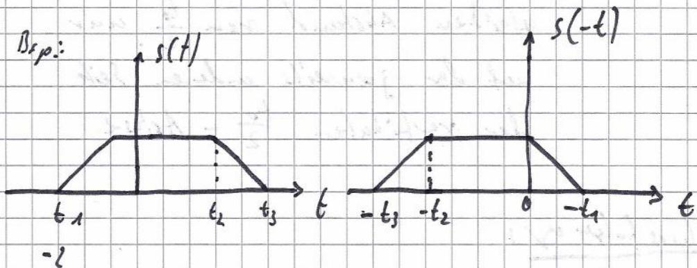
3. Einfluss eines negativen und von  $t_0$  verschobenen Argumentes  $t$ :
