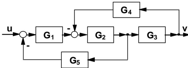
A6. Formen Sie den Wirkungsplan so um, daß Sie in der Lage sind, die Übertragungsfunktionen für beide Eingangsgrößen zu berechnen!
