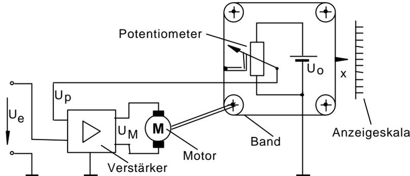
Der Übertragungsfaktor des mit dem Band gekoppelten Potentiometers ist
