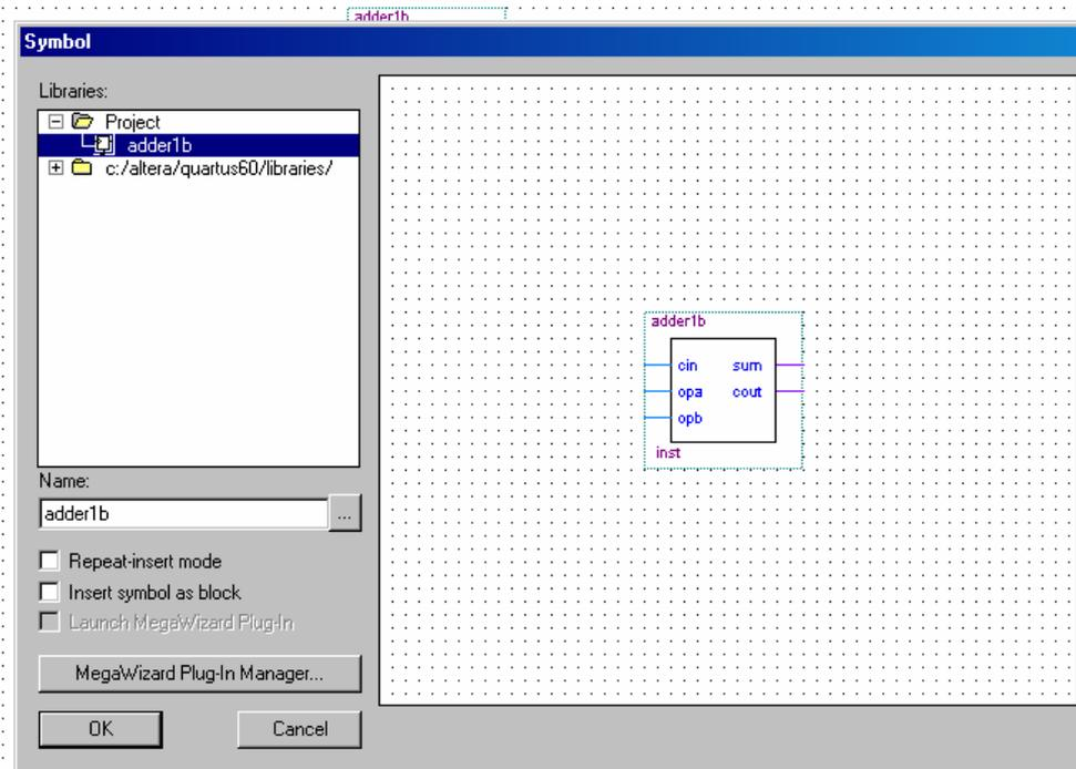
**Symbole für den 4 Bit Addierer und für Inputs und Outputs platzieren und verbinden**
