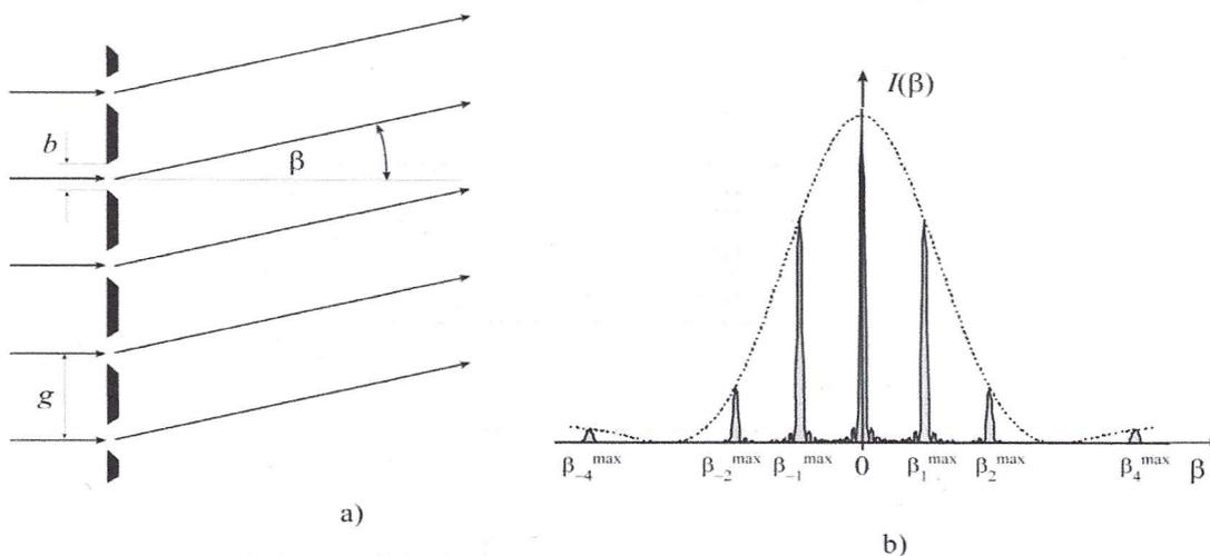
Abb. 4: Beugung am realen Amplitudengitter.
