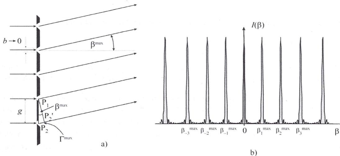
Abb. 3: Fraunhofer-Beugung am idealen Gitter
