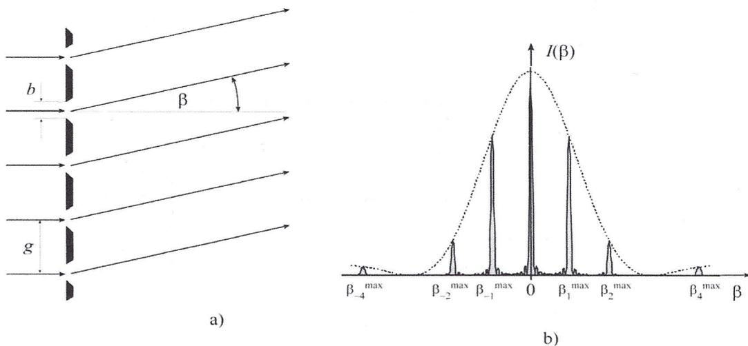
Abb. 4: Beugung am realen Amplitudengitter.
