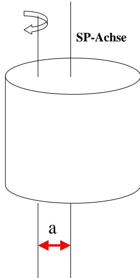
$$J_{\text{Drehachse}} = J_{\text{SP-Achse}} + m a^2$$
