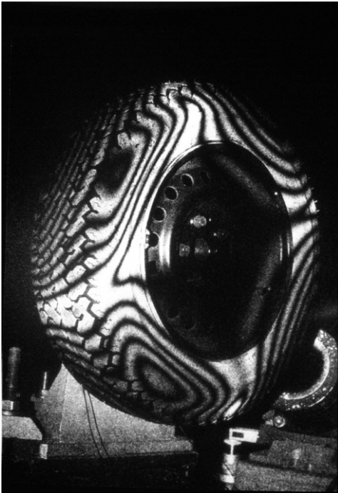
Bild 23.15. Holographische Interferometrie zur Untersuchung von Autoreifen. Es wurden zwei Hologramme mit einem höheren und niedrigeren Druck im Reifen aufgenommen. Die Interferenzlinien zeigen die Ausdehnung des Reifens an. Unregelmäßigkeiten deuten auf Fehler in der Fertigung hin
