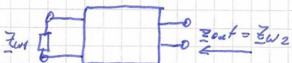
Diese Definition des Wellenwiderstands ist nur für passive Vierpole sinnvoll.
