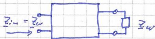
Wird an den Eingang eines symmetrischen Vierpols der Wellenwiderstand geschaltet, dann ist der Ausgangswiderstand  $\underline{Z}_{out}$  gleich diesem Wellenwiderstand:
