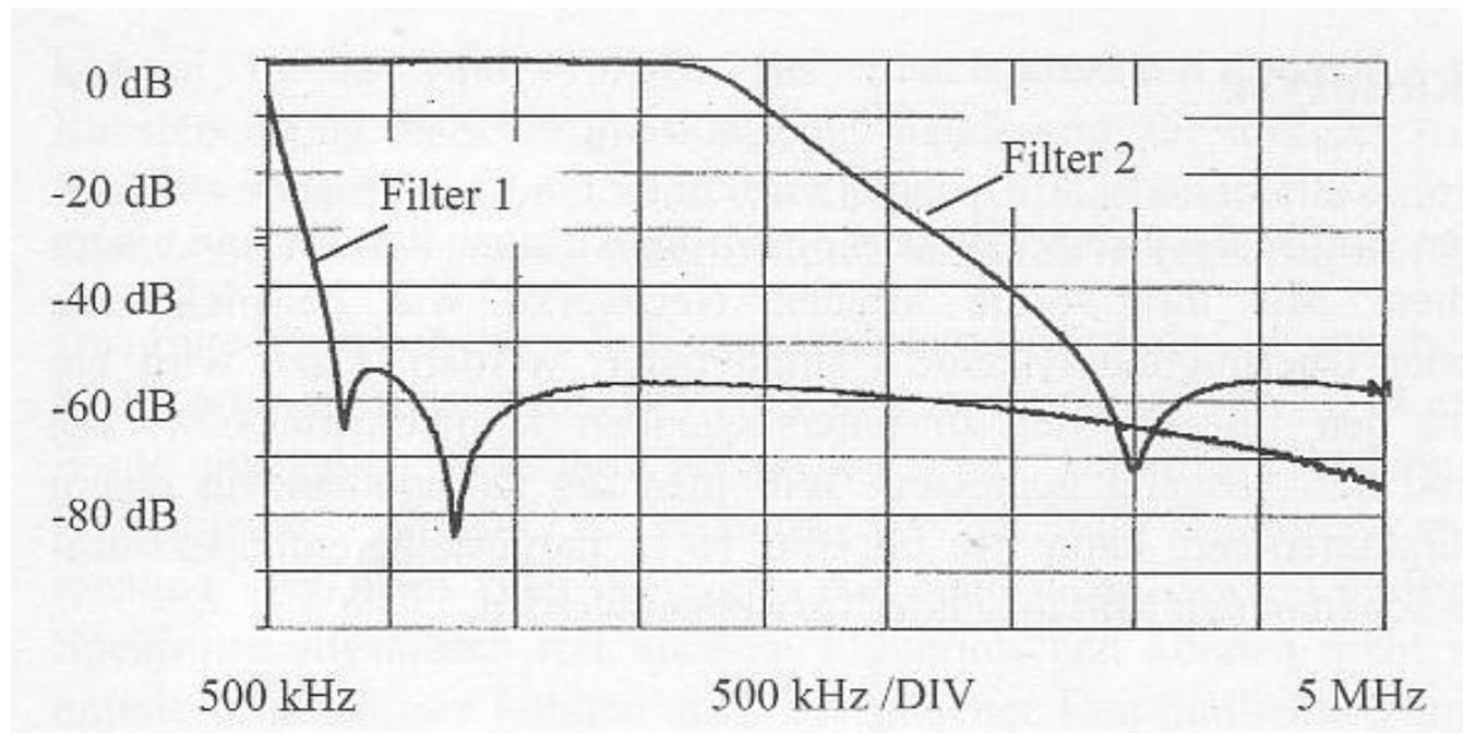
Amplitudengänge zweier Tiefpassfilter ( $f_{g1} < 500 \text{ kHz}$ ,  $f_{g2} = 2,3 \text{ MHz}$ )
