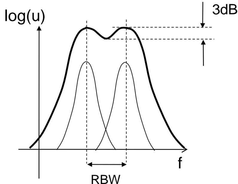
2 Signale gleicher Amplitude ( $B_{\text{signal}} \ll \text{RBW}$ )
