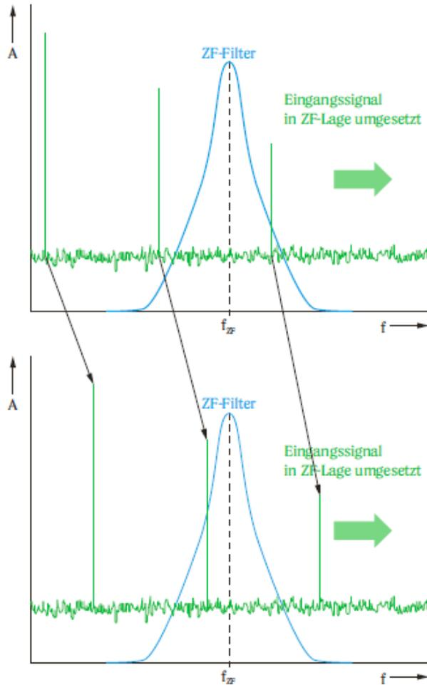
gesamtes Signal (ZF-Signal) wird am (festen) Filter „vorbeigeschoben“
