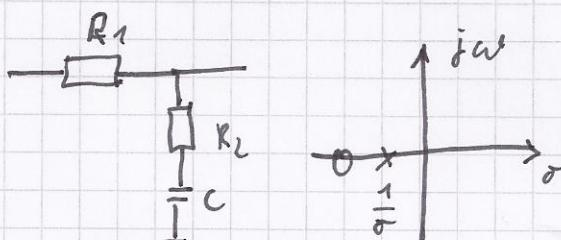
$$\frac{1 + j\omega R_2 C}{1 + j\omega (R_1 + R_2) C}$$
