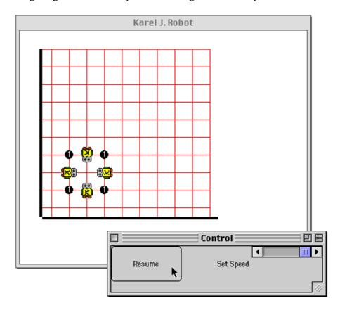
Die Programmierung erfolgt in Java mit einem Texteditor. Es steht eine vordefinierte Roboter-Klasse ur\_robot zur Verfügung. Vor der Ausführung muss das Karel-Programm zusammen mit den Bibliotheken mit javac compiliert werden.
