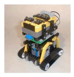
Die Kara-Programme werden in NQC-Programme zur Steuerung des Lego-Mindstorm-Roboters übertragen.
