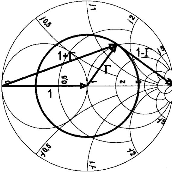
Zur Bestimmung der relativen Amplituden von Spannungs- und Stromstehwelle sowie des Stehwellenverhältnisses und des Anpaßfaktors
