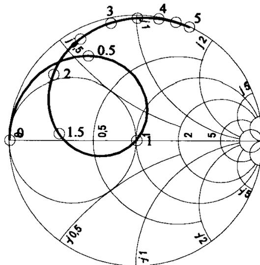
Frequenzgang der dargestellten Schaltung für die normierten Frequenzen 0 bis  $5\omega/\omega_0$
