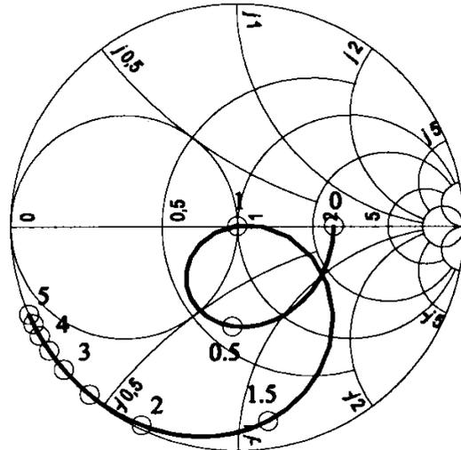
Frequenzgang der dargestellten Schaltung für die normierten Frequenzen 0 bis  $5\omega/\omega_0$
