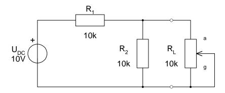
Der Widerstand R<sub>L</sub> wird durch ein Potentiometer realisiert. Auf der Skala sind die Markierungen a – g aufgetragen, die sechs gleiche Teile des Stellbereiches markieren.
