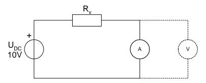
Bauen Sie die angegebene Messschaltung auf und stellen Sie die vorgegebene Spannung ein! Messen Sie die Ströme in der Messschaltung und die Spannungen über dem Amperemeter für die in der Tabelle 1 angegebenen Strommessbereiche bei den jeweils geforderten Reihenwiderständen.
