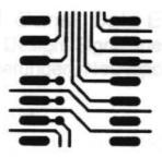
Pad 0.6 \* 2.0mm | Pad 0.6 \* 2.0mm | Pad ungebohrt | Pad ungebohrt | 200ym Track 180ym Via 300ym Abstand 180ym
