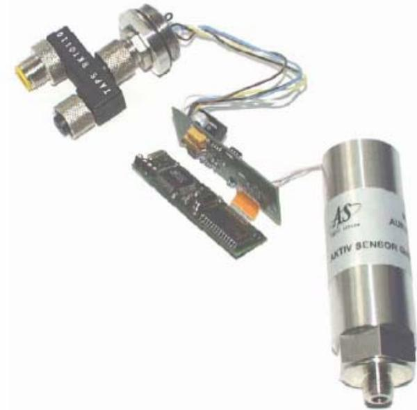
Feldbusfähiger Drucktransmitter mit CAN-Interface vorhanden
