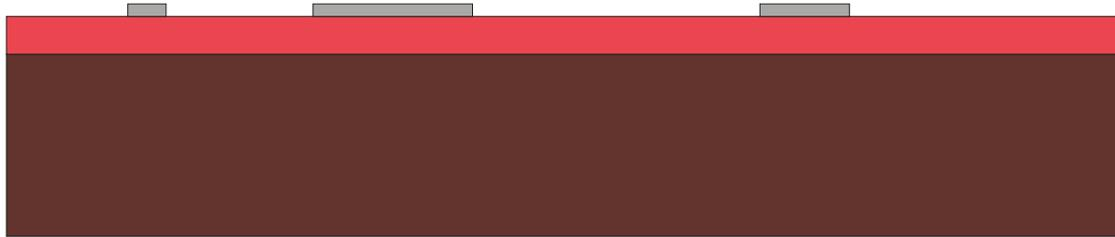
7. Ätzen der Leiterplatten (unbedecktes Kupfer wird gelöst)
