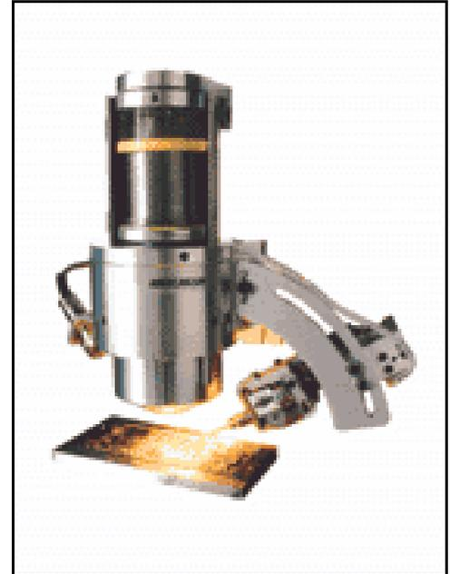
Die Übertragung der Wärme zum Aufschmelzen des unteren Verbindungspartners erfolgt nur durch Wärmeleitung, so dass der Bauteilanschluss und die Kontaktierfläche in einem guten thermischen Kontakt stehen müssen.
