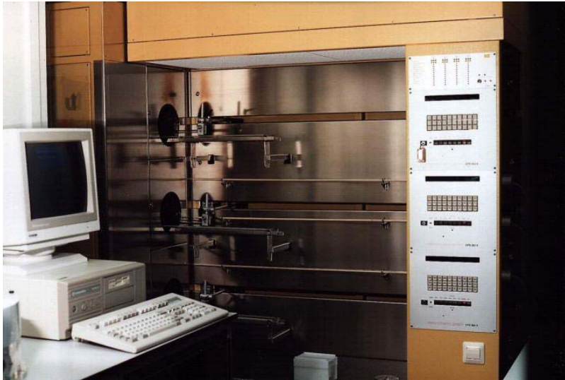
Bilder: Oxidationsofen (3 Rohre)
