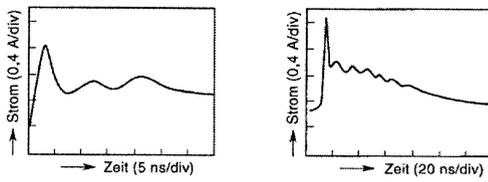
**a** Person auf 3 kV aufgeladen, Entladung über einen in der Hand gehaltenen Schraubendreher, a) 5 ns/div
