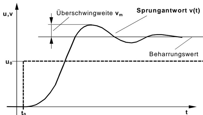
Die Sprungantwort ist der zeitliche Verlauf der Ausgangsgröße  $v(t)$  eines Übertragungsgliedes nach einer sprungförmigen Änderung der Eingangsgröße  $u(t)$ .
