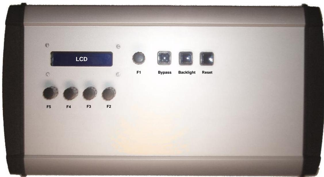
Bild 45: Ein- und Ausgabeelemente der Benutzerschnittstelle
