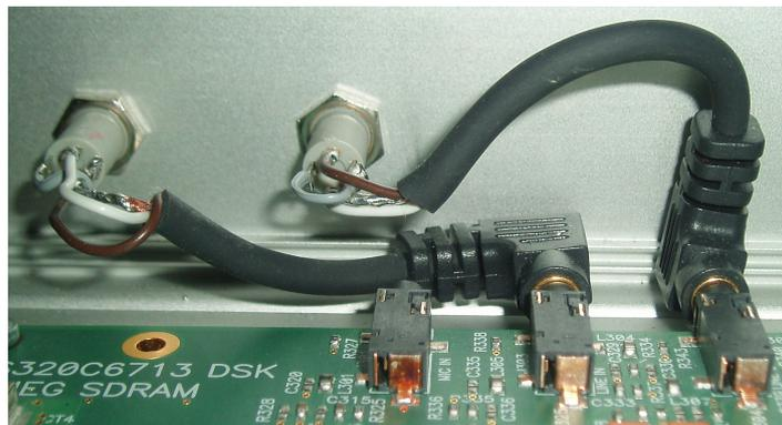
Bild 38: Audioverbindung zwischen DSK und den Klinken-Buchsen
