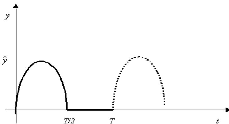
$$a_0 = \frac{2\hat{y}}{\pi}, \quad a_n = \begin{cases} 0 & \text{für } n = 1 \\ 0 & \text{für } n > 1 \text{ ungerade} \\ -\frac{4\hat{y}}{2\pi(n+1)(n-1)} & \text{für } n > 1 \text{ gerade} \end{cases}$$
