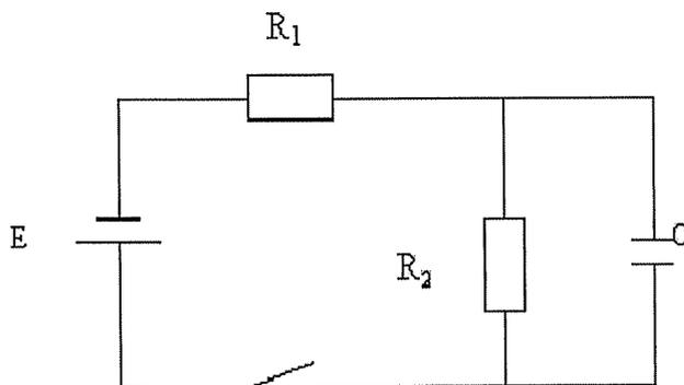
Für die Kondensatorspannung  $u_c$  gilt während des Einschaltvorganges die Differentialgleichung
