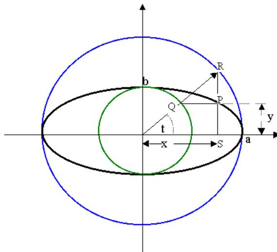
Man fällt von einem beliebigen Punkt  $R$  des Umkreises das Lot auf die  $x$ -Achse (Punkt  $S$ ). Der Ortsvektor  $\vec{OR}$  schneidet den Innenkreis im Punkt  $Q$ . Die zur  $x$ -Achse parallele Gerade durch  $Q$  schneidet das Lot im Punkt  $P(x; y)$  von dem, man zeigen kann, das er ein Ellipsenpunkt ist. Es gilt
