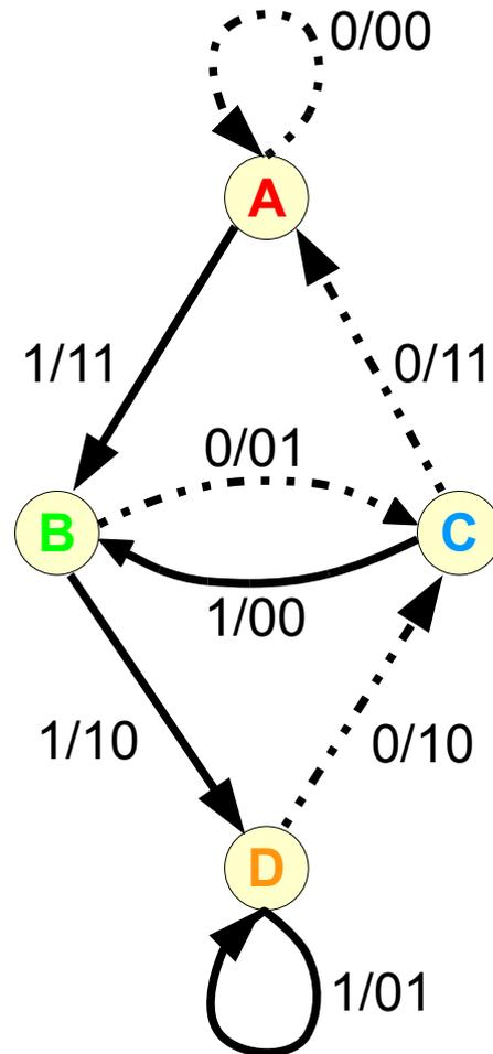
Ziel: großer Unterschied der Ausgangsdaten bei jeder Entscheidung
