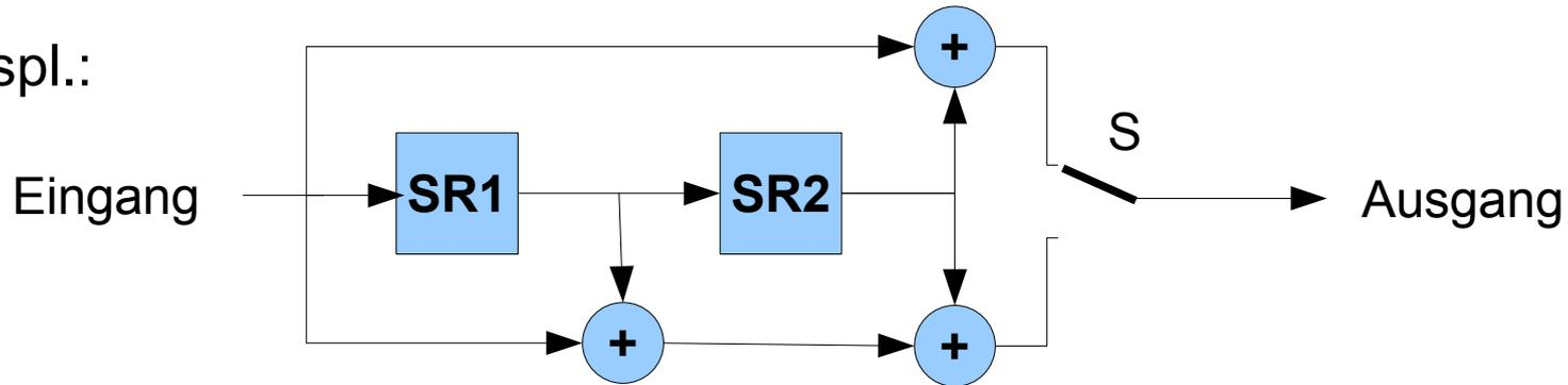
Constrained length (Constrained Länge) = 3 - Tiefe Gedächtnis
